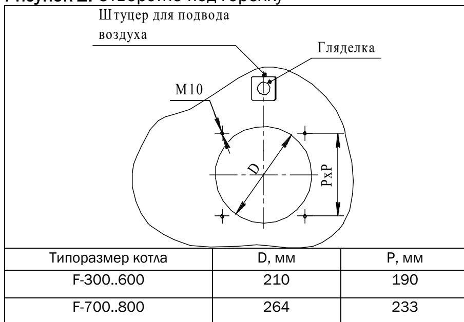
Рисунок 2. Отверстие под горелку
